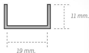
**Para recubrimiento de cantos con abertura de 19 mm.**
