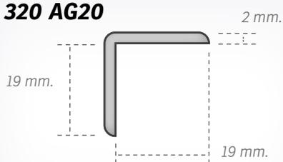
**Ángulo 20.** Para protección de aristas espesor 2mm.
