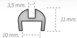
**Terminal vidrio.** Para sosten de paño viadriado sobre placa de hasta 10mm.
